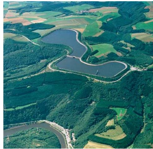
**Erprobte Technik: Pumpspeicherkraftwerke sind seit Langem im Einsatz. In der Bildmitte das obere Speicherbecken.**
