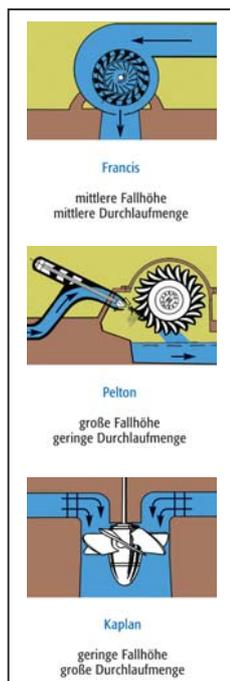
Turbinentypen (Abb. 6.1): Für jeden Einsatzzweck das passende Modell.
